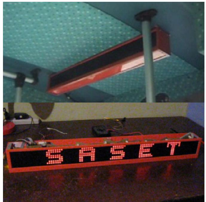
**Figura 6.** Módulo instalado en bus de transporte público
